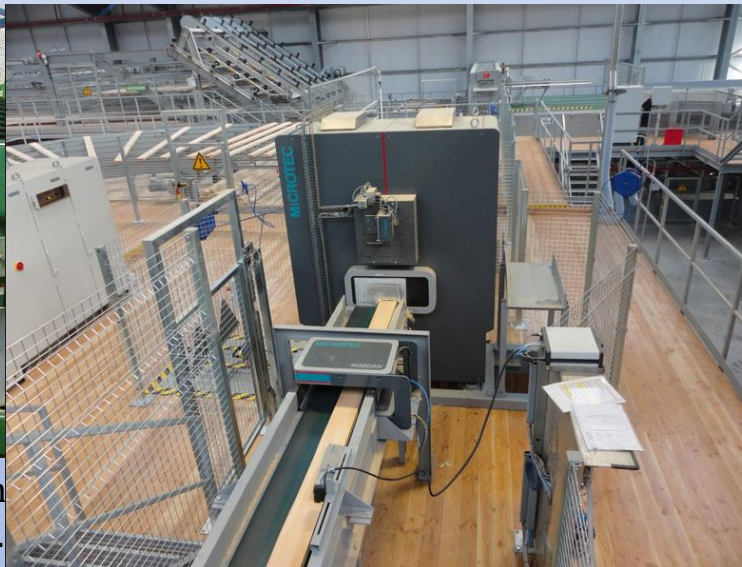
Microtec Goldeneye – Röntgendurchstrahlung/ Laserabtastung (Bildquelle: www.microtec.eu )
