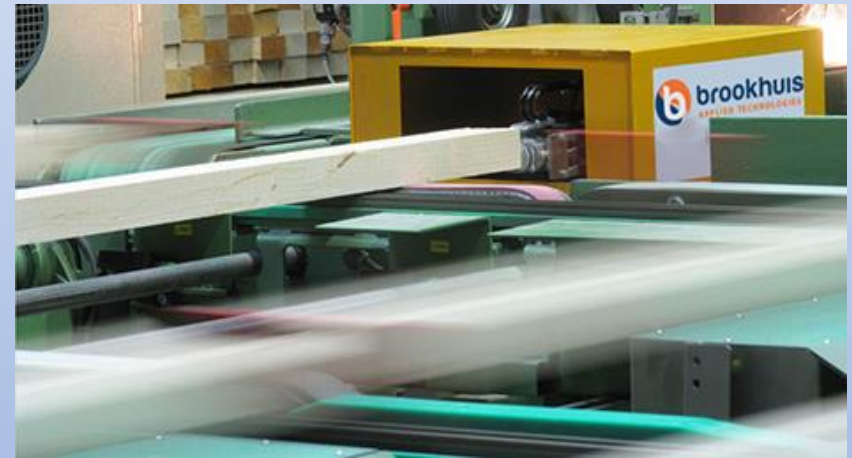
brookhuis mtgBATCH – Längsschwingungs- messung (Bildquelle: www.brookhuis.com )
