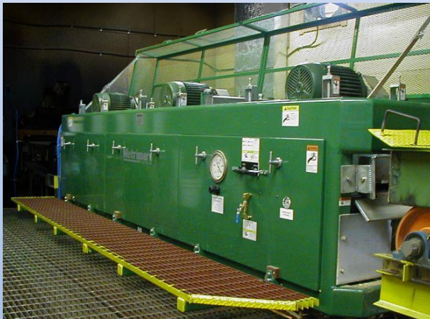
RAUTE Timbergrader – Durchbiegungsmessung (Bildquelle: www.metriguard.com )
