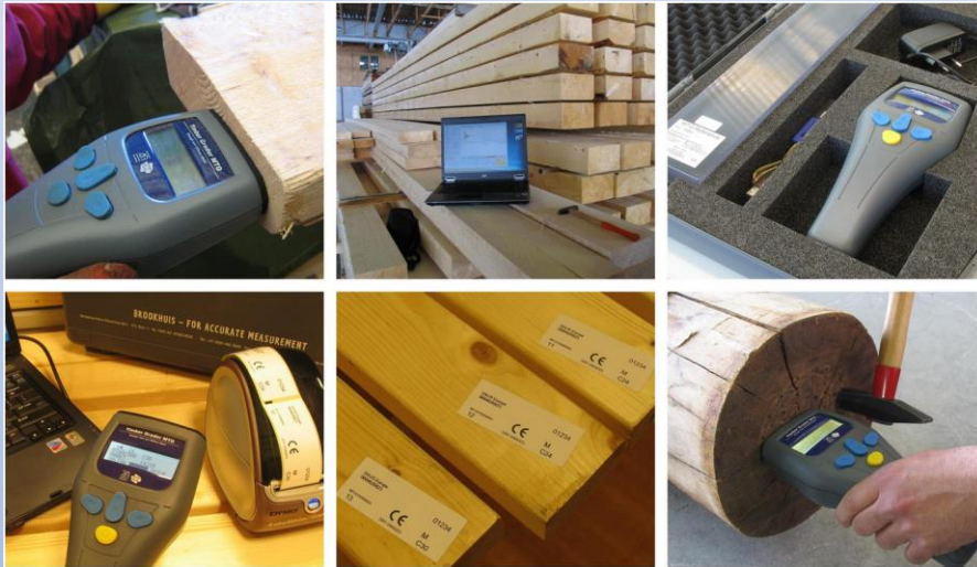
brookhuis Timber Grader MTG handheld– Längsschwingungsmessung (Bildquelle: www.volta.it )
