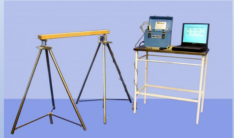
Metriguard E-Computer – Längsschwingungsmessung (Bildquelle: www.metriduard.com )
